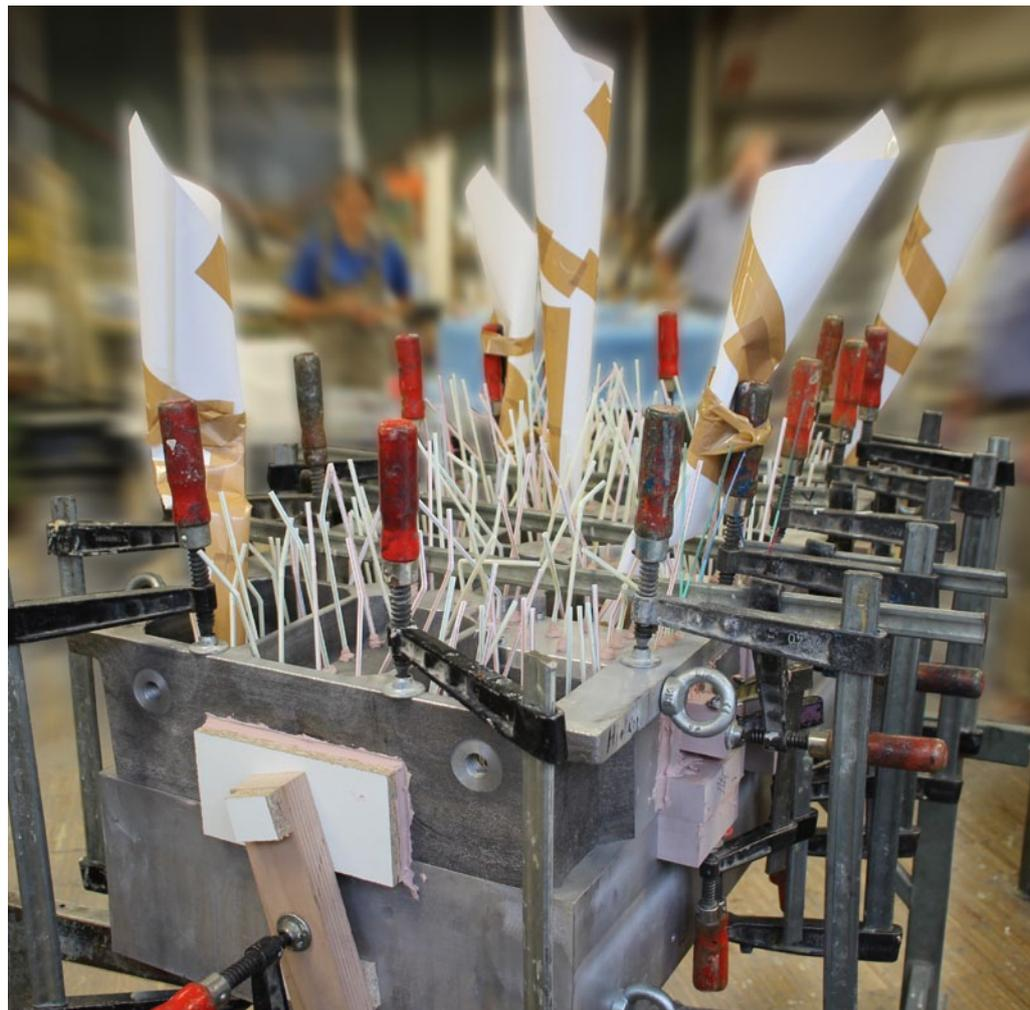
**Bild 2:** Kernkasten optimal von der Modellbau Steigerwald GmbH, Karlsbach, zum Frontschichtguss vorbereitet. | Foto: Modellbau Steigerwald
