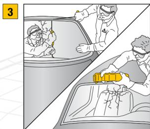
3 Die beschädigte Scheibe mit Vibrationsmesser, Trenndraht, Kaltmesser oder einem vergleichbaren Werkzeug ausschneiden.
