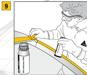
9 Karosserieflansch mit Wasser reinigen und die Haftfläche mit Sika® Aktivator PRO vorbehandeln.
