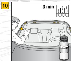
10 Kleinere, beim Ausbau entstandene Lackschäden mit Sika® Primer-206 G+P korrigieren. Bei grösseren Schäden mit einem schnellen Original-Reparatlack ausbessern oder die Karosserie-Werkstatt kontaktieren.
