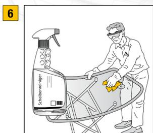
6 Die neue Scheibe mit Scheibenreiniger reinigen.
