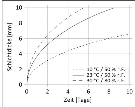
Diagramm 1: Durchhärtengeschwindigkeit von Sikaflex®-254
